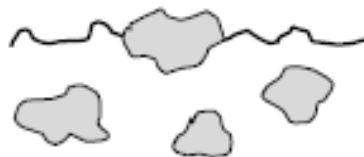
(d) Surface inclusions (metallic; e.g., from composite contacts)
